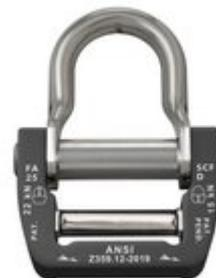
Die COBRAFRAME 18 kN Rückfädelschnalle aus Aluminium mit beweglichem Mittelsteg aus Edelstahl und D-Ring aus Edelstahl entspricht dem ANSI Z359.12-2019 Standard und überzeugt mit 15 kN Bruchkraft auf geraden Zug. In Verbindung mit dem passenden Gurt garantieren wir jedoch 18 kN für die Schnalle und 22 kN für den D-Ring und weisen dies in den technischen Daten entsprechend aus.
