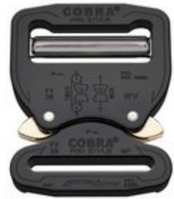
Die COBRA® PRO STYLE ist die stärkste und weltweit führende Sicherheits-Schnalle aus Aluminium. Dank ihres patentierten Verschlussmechanismus und hohen Bruchkraftwerten bietet sie das höchste Maß an Sicherheit. In Verbindung mit dem passenden Gurt hält der Verschluss garantiert 9 kN auf geraden Zug und 18 kN in der Umreifung.
