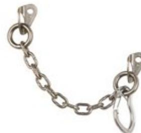
Kettenstand mit zwei 12 mm Laschen, einer Kette und einem MICRO Drahtbügelkarabiner mit Splint. Der empfohlene Bohrlochabstand beträgt 25-30 cm.
