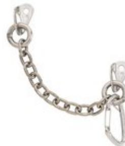
Kettenstand mit zwei 10 mm Laschen, einer Kette und einem STEELEVEN Edelstahl-Karabiner mit Drahtbügel und Splint. Der empfohlene Bohrlochabstand beträgt 25-30 cm.
