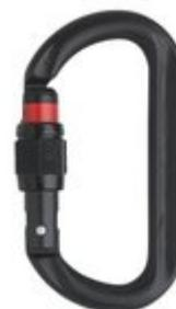
OVALO - der Yogi unter den Karabinern: die ovale Form begünstigt in jeder Situation die optimale Ausrichtung des Karabiners nach der Längsachse und vermindert somit gefährliche Querbelastungen. Durch den runden Querschnitt wird zusätzlich das Seilhandling optimiert. Ovalkarabiner mit Schraubverschluss und rundem Querschnitt.
